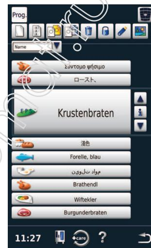
При нажатии кнопки "Programm" аппарат включается в режим программирования.
